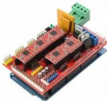
Figura 15. Drivers instalados en Ramps 1.4
