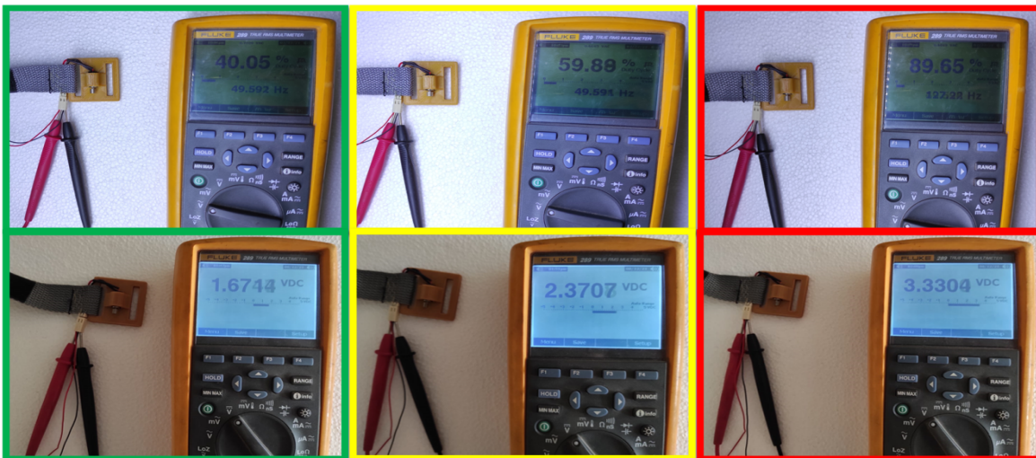
Figura 50. Medición del voltaje obtenido según el ciclo de trabajo del motor vibrador. Elaboración Propia.
