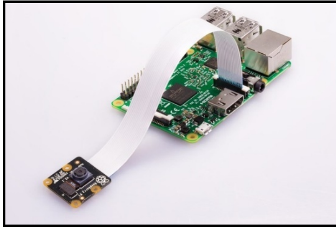
Figura 12. Cámara Pi NoIR V2 Fuente: Fundación Raspberry Pi. (Raspberry, 2016).
