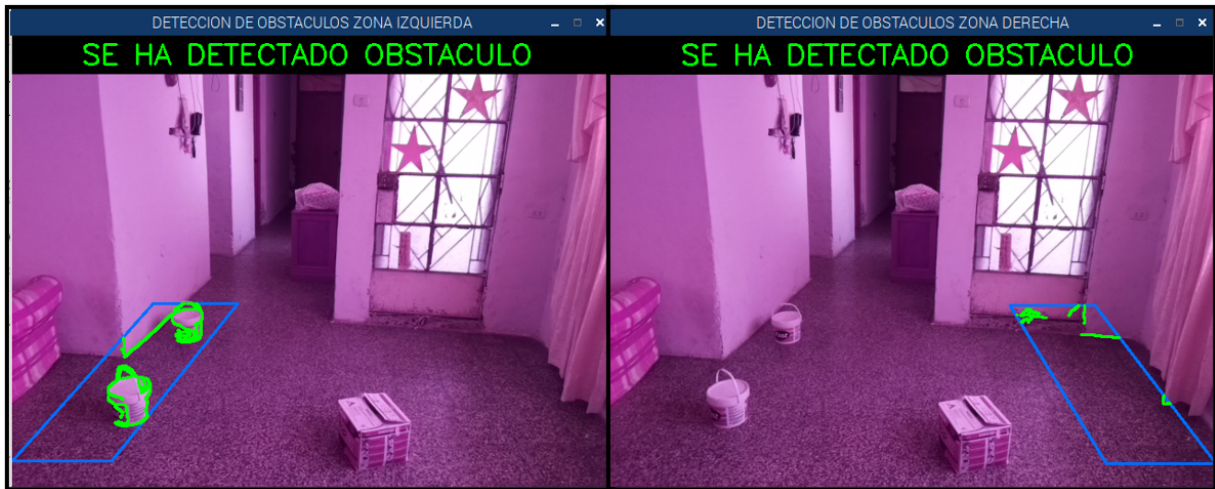
Figura 39. Intersección de obstáculos encontrados en la zona lateral izquierda y derecha. Elaboración Propia.
