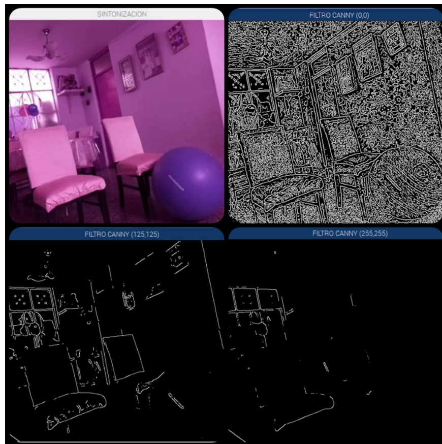
Figura 17. Filtro Canny con los parámetros (0, 0) , (125, 125) , y (255, 255) . Elaboración Propia.
