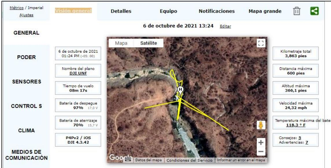
En la figura 8 se detalla el recorrido del vuelo del dron en el recurso.
