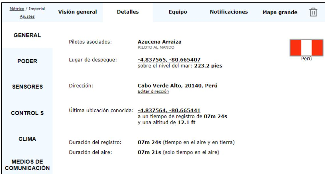
En la figura 25 se observan los detalles entre ellos el lugar de despegue: -4.837565, -80.665407, la altitud 68 msnm (223.2) y la dirección.
